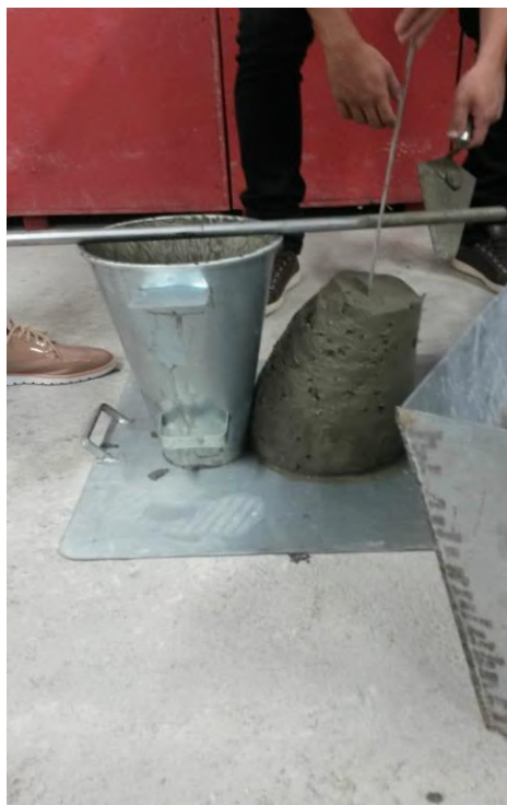
Figura 1 - Slump Teste. Fonte: AUTORAS, 2018.
