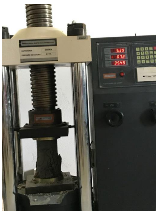
Figura 3- Rompimento do concreto com resíduos de borracha.
