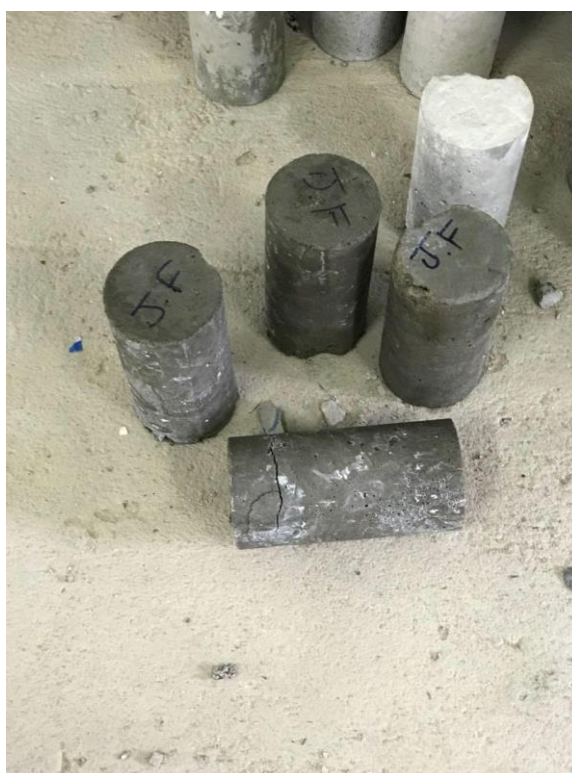
Figura 4 - Rompimento do concreto convencional resíduos de borracha.
