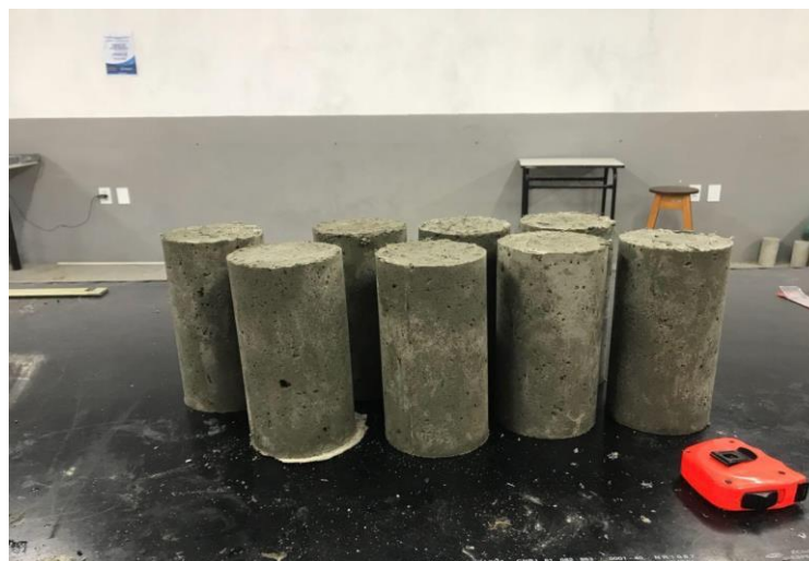
Figura 2 - Após desenformar dos corpos de prova.
